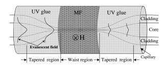
✓ 光纤磁流体调制器 Fiber magnetic fluid modulator
